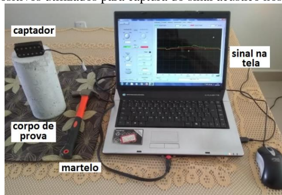
Figura 3 - Dispositivos utilizados para captura do sinal acústico nos corpos de prova.
