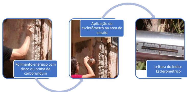
Figura 5: Esquema de execução do ensaio de esclerometria.
