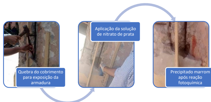
Figura 4 - Esquema de execução do ensaio de cloretos.
