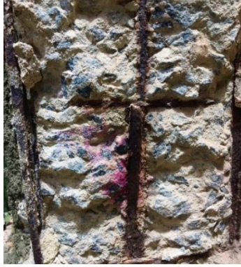
Figura 6: Coloração vermelho carmim, característico de concreto com pH alcalino.
