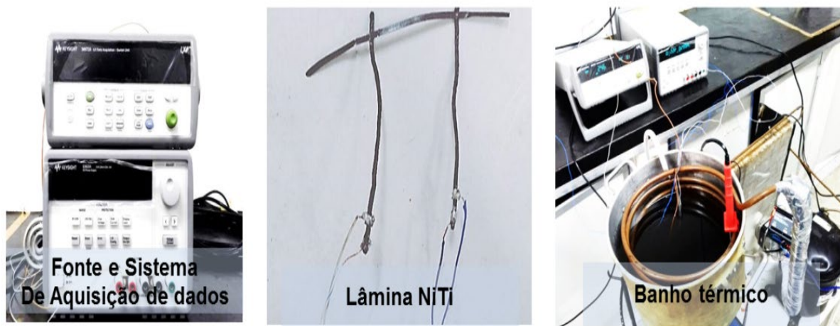
Figura 4- Lâmina de NiTi conectada a fonte elétrica e imersa no banho térmico
