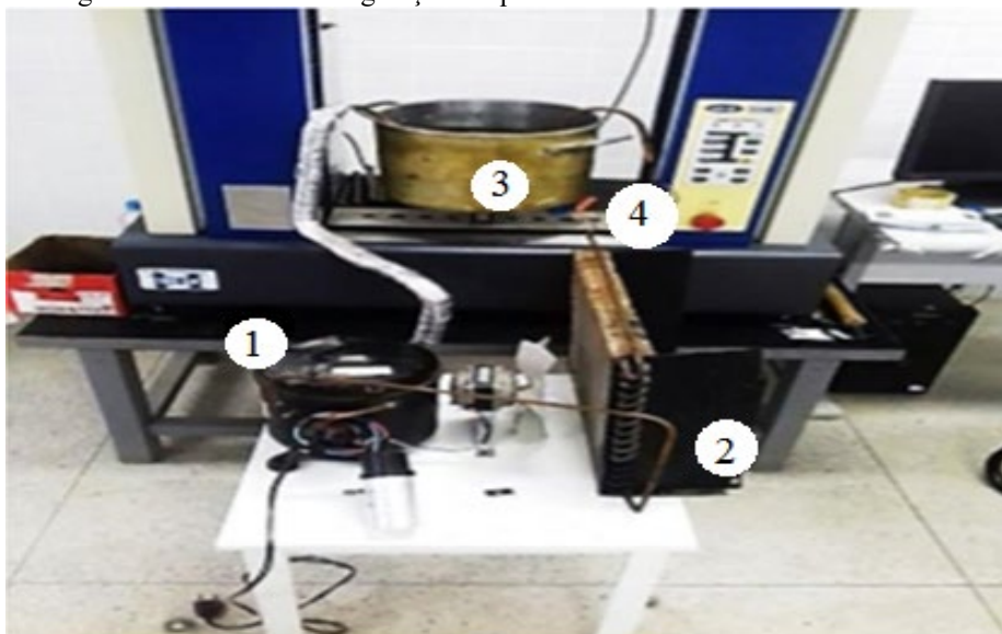
Figura 2- Sistema de refrigeração e aquecimento utilizados durante os ensaios
