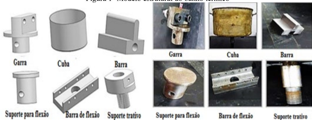
Figura 1- Modelo estrutural do banho térmico
