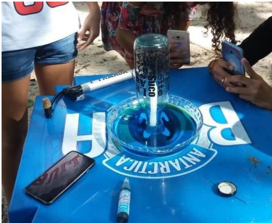
Figura 1 – Experiência que permite observar a ação da pressão atmosférica.
