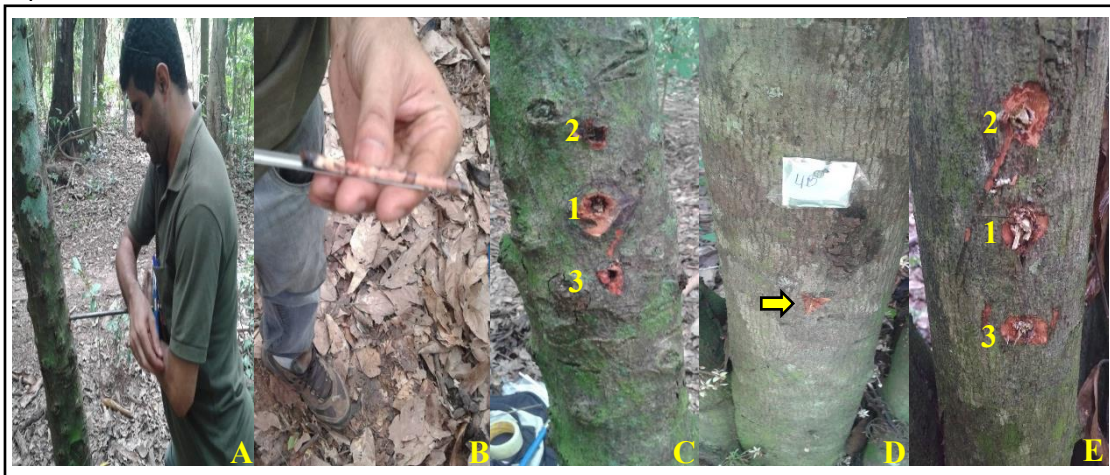
Figura 1. (A) Uso do trado de Pressler para retiradas das amostras não destrutiva do lenho; (B) Bagueta para análise das injúrias; (C) Pontos da retirada do material lenhoso; (D) Realização da injúria na camada cambial; (E) Amostragem do lenho após dois anos.
