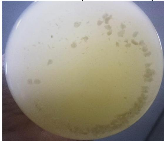
**Teste de Degradação de Petróleo:** Foi observada a degradação do petróleo nos tempos de 0h (sem ação do produto), 24h e 144h. Para observar efetivamente, era necessário agitar o frasco. Ao colocar o produto, o petróleo não se dissolvia no meio mineral e não se desprendia da parede do frasco (Figura 6 - A). Em seu plaqueamento, como esperado não houve crescimento (Figura 6 - B). Depois de 24h,
