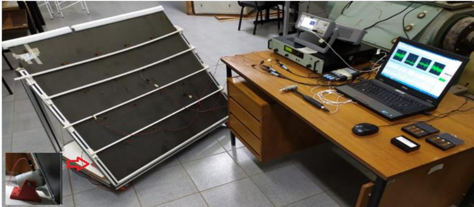
Figura 1: Bancada de vibração com Structural Health Monitoring, Impact Hammer Test .
