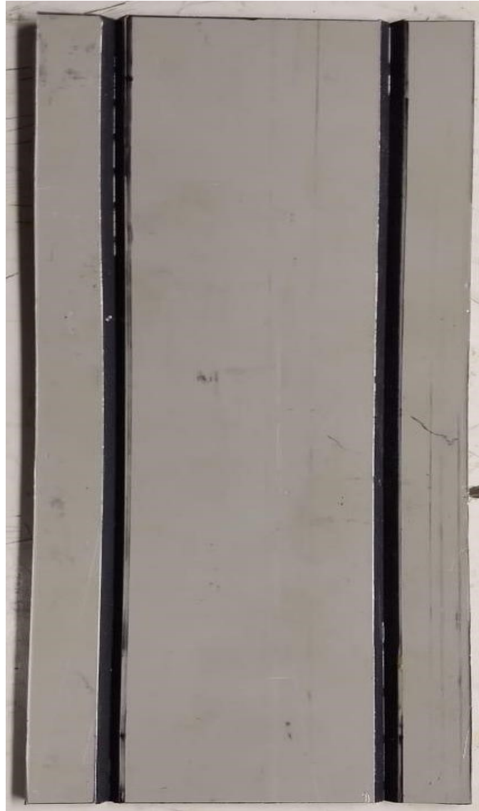
Figura 7: Chapa de ACM com rasgo em V, rampa de potes
