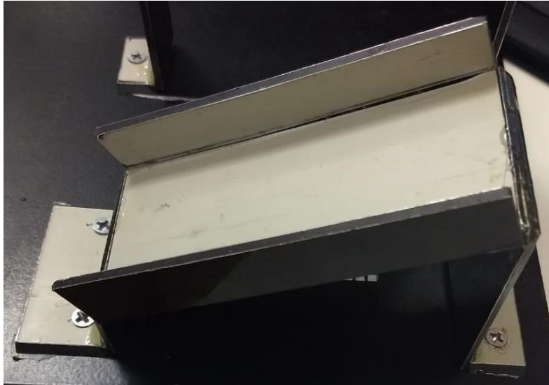
Figura 8: Rampa de potes fabricada
