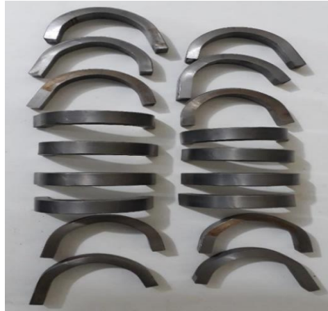
Figura 7. Corpos de prova após os ensaios de dobramento lateral das amostras 1, 2 e 3
