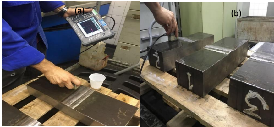
Figura 8. (a) Ensaio de ultrassom, (b) Inspeção de descontinuidades [Fonte: Autor]
