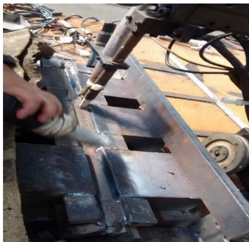
Figura 2. Soldagem das amostras pelo processo de arco Submerso [Fonte: Autor]
