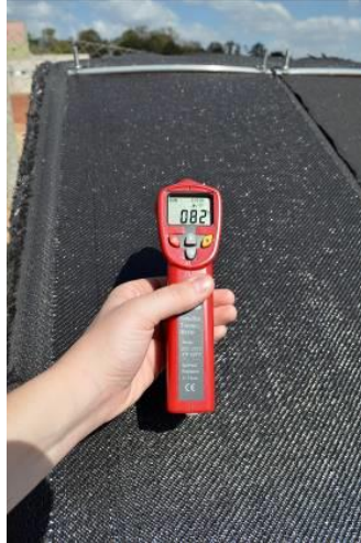
Figura 2. Termômetro de infravermelho empregado no estudo de intemperismo.
