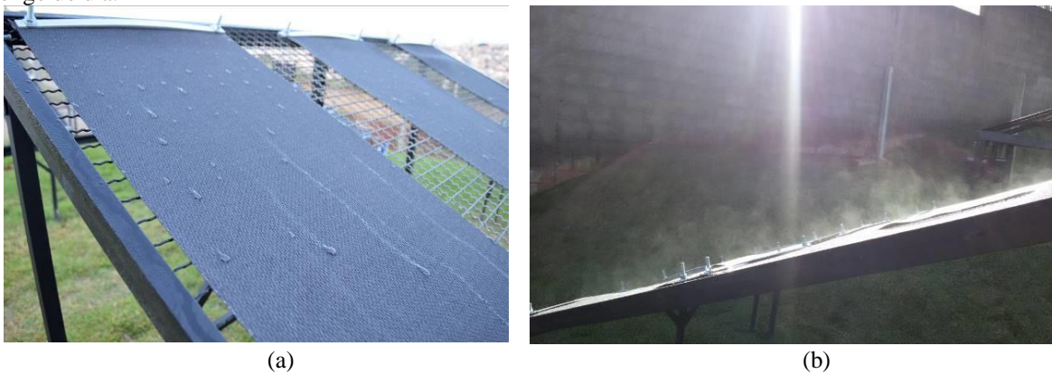
Figura 5. Presença de orvalho na superfície do geotêxtil: a) Detalhes; (b) Evaporação com o aumento da temperatura ao longo do dia.
