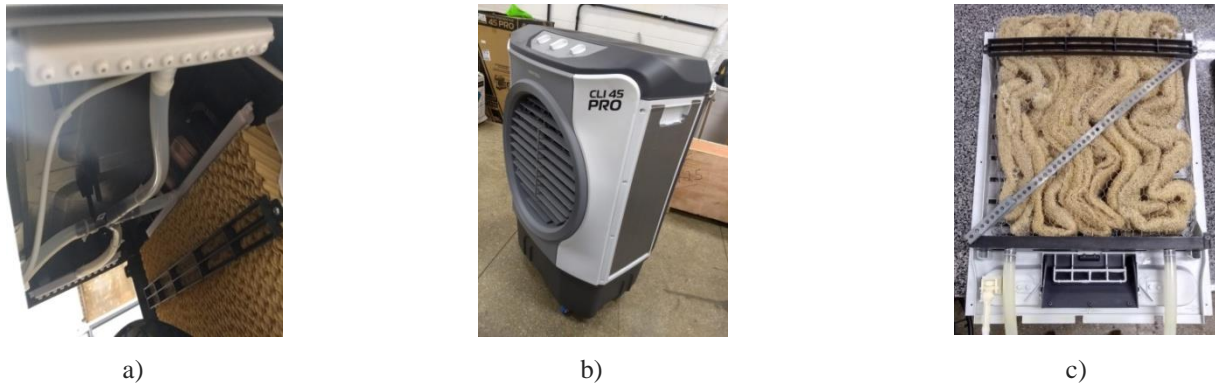
Figura 5 – Vistas: a) lateral interna do sistema; b) lateral com vedação; c) Suporte para colmeia.
