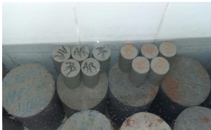
Figura 06 – corpos de prova submersos em tanque com água (fotos de autoria própria-2020)
