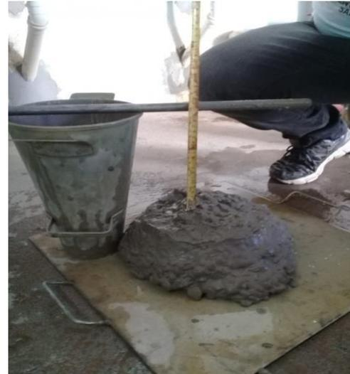
Figura 10 – Altura do adensamento (Autor, 2020)
