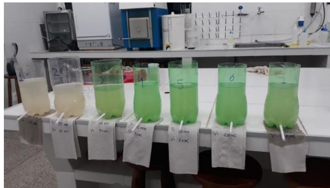
Figura 2 – Garrafas PETs utilizado do tratamento de 1 L de água de cisternas com Moringa oleifera .
