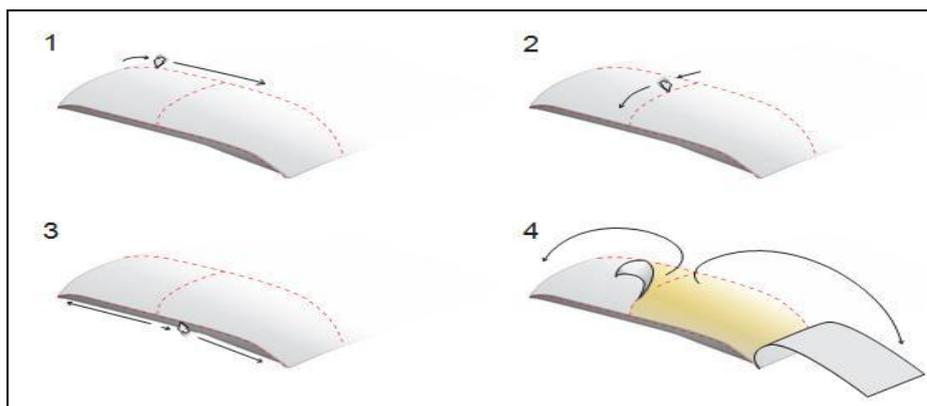
Figura 3: Esquema de retirada da cobertura do geobag
