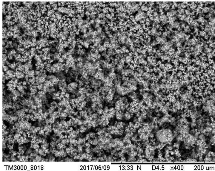
Figura 5: MEV da amostra de lodo de chorume, com zoom x400.
