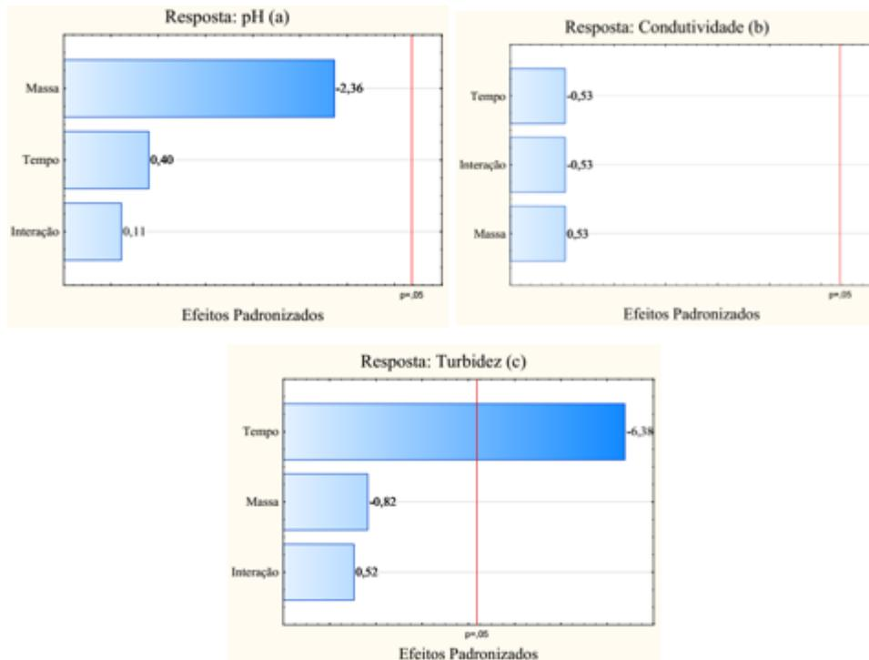
Figura 6 – Diagramas de Pareto para os efeitos padronizados em  $p = 0,05$ , para as repostas pH (a), condutividade elétrica (b) e turbidez (c), aplicando o sulfato em pó como coagulante.
