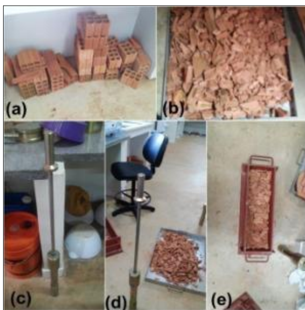
Figura 11. Resíduos cerâmicos: (a) RCV coletado; (b) RCV fragmentado; (c) soquete utilizado na fragmentação; (d) armazenagem após fragmentação; (e) aplicação de golpes do soquete
