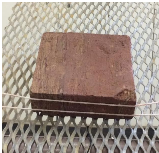
Figura 4. Corpo de prova pronto para ser ensaiado no Inderbitzen.
