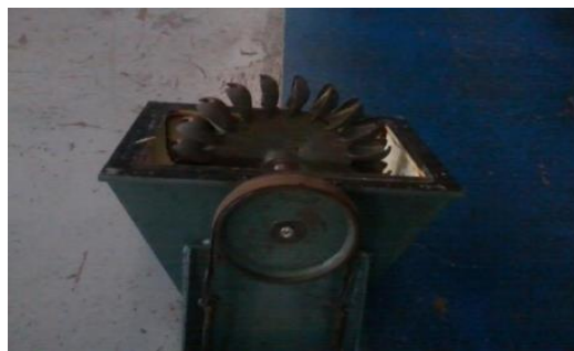
Figura 5: Carcaça aberta de Turbina Pelton
