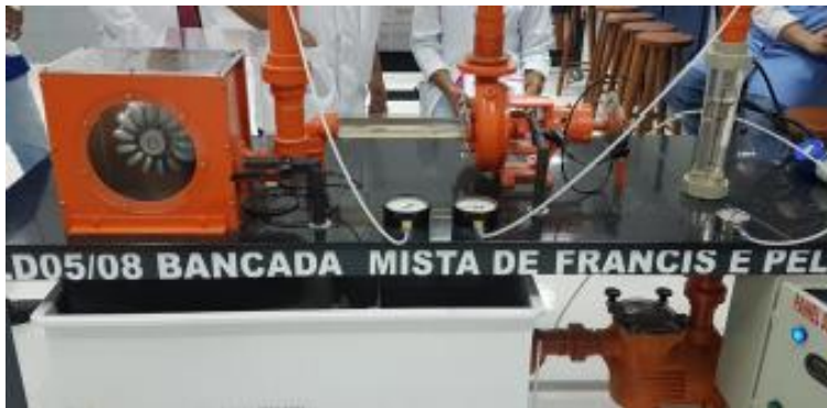
Figura 2: Bancada de ensaios Pelton/Francis do laboratório da FER
