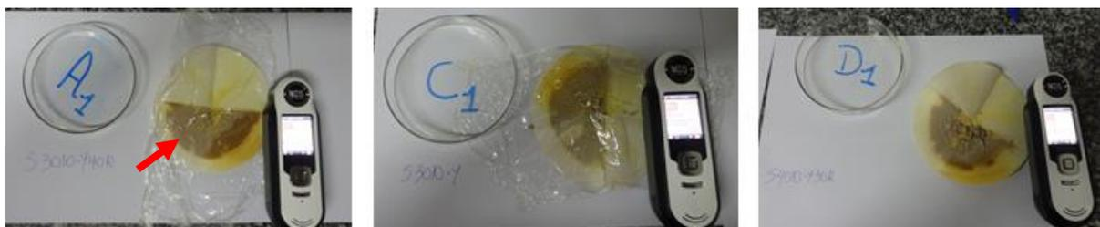
Figura 9: Aferição da cor dos finos das amostras **A<sub>1</sub>**; **C<sub>1</sub>** e **D<sub>1</sub>**; uso do colorímetro digital NCS (Natural Color System) modelo RM 200. Amostra **A<sub>1</sub>**, Traço provável com características antigas. Fonte: Eder Silva, jun.
