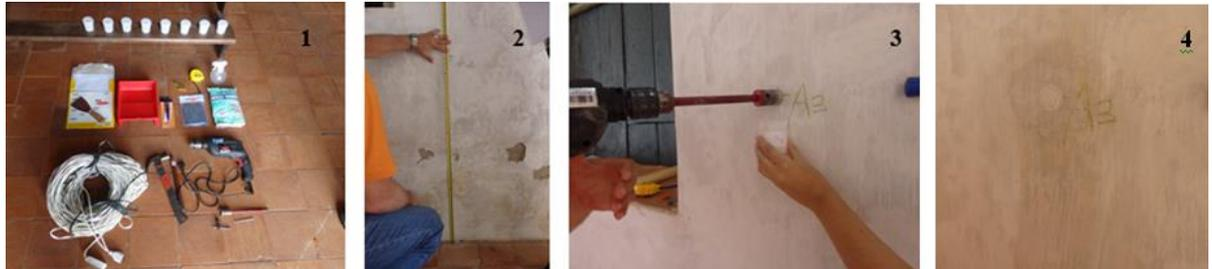
Figura 08: (1) - Equipamentos para extração e recolha das amostras e posterior fechamento da perfuração; (2) - Posicionamento recolha amostra **A<sub>1</sub>**; (3) - Perfuração amostra **A<sub>3</sub>**; (4) – Fechamento da perfuração com gesso amostra **A<sub>3</sub>**. Fonte: Eder Silva, jun. 2018.
