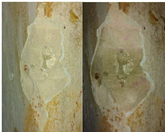
Figura 12 – P14 antes da aplicação da fenolftaleína (esquerda) e após aplicação (direita) . (Fonte: autores)
