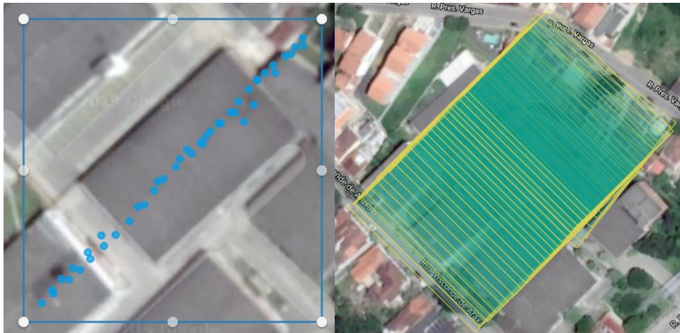
Figura 3– (a) Pontos onde mostram a localização de todas as fotos tiradas pelo drone e (b) Imagens visualizada nas suas respectivas posições.
