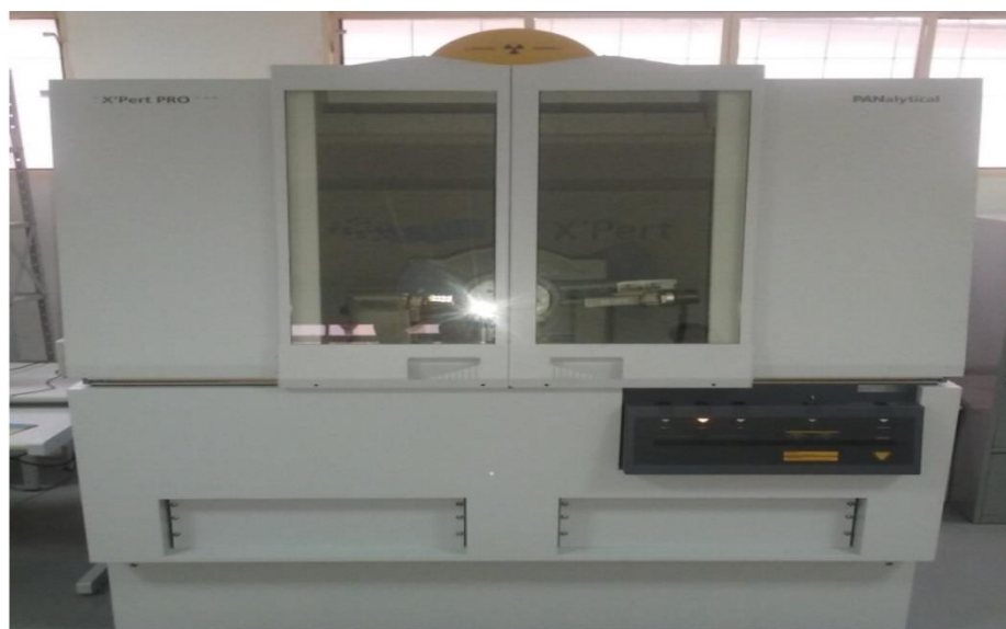
Figura 5 – Difratômetro Panalytical X'Pert Pro – Equipamento utilizado para a análise de DRX
