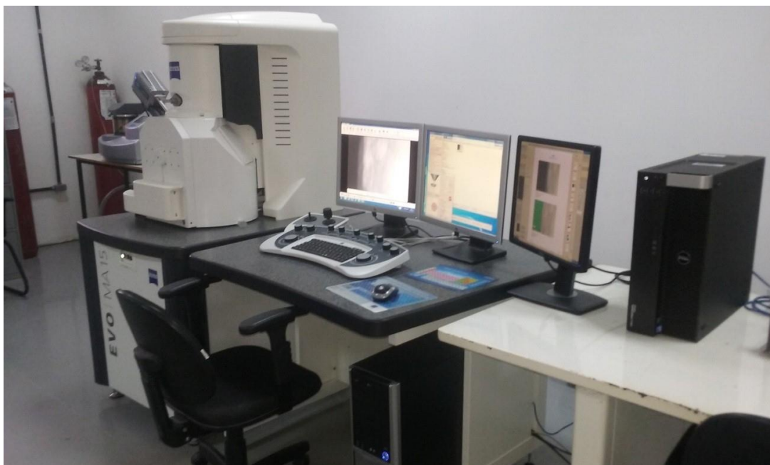
Figura 6 – Microscópio Eletrônico de Varredura utilizado para o caracterização das partículas e o EDS
