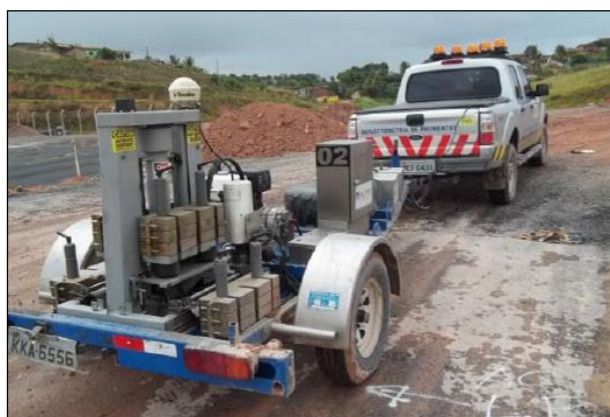
Figura 3 – Realização do levantamento deflectométrico
