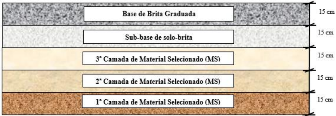
Figura 11 – Composição do pavimento conforme o Projeto
