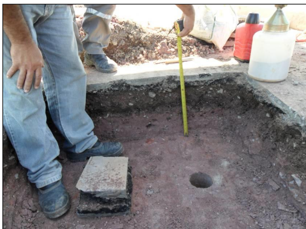
Figura 13 – Verificação da espessura da camada na Janela
