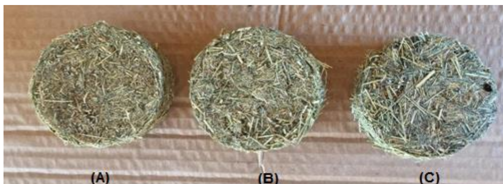
Figura 3: Briquetes confeccionados a partir de diferentes métodos. (A) Método 1, (B) Método 2 e (C) Método 3. Fonte: Arquivo pessoal (2018).
