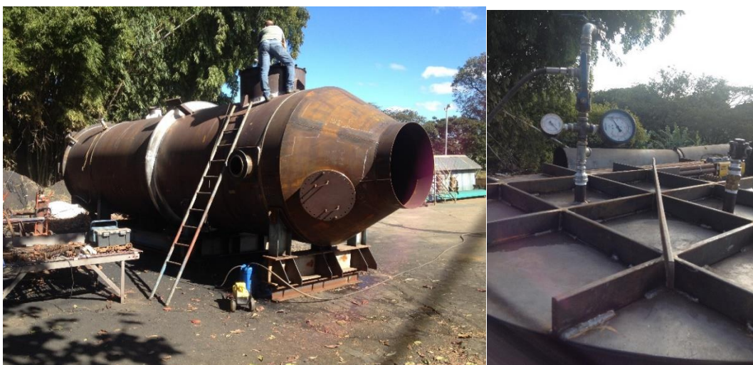
FIGURA 11. Teste Hidrostático com o Jato de água
