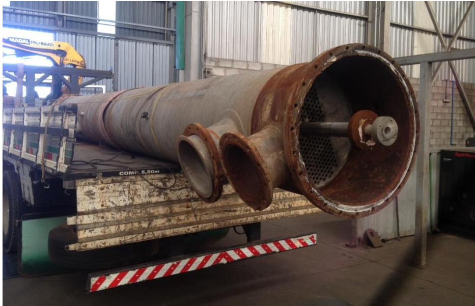
FIGURA 2. Trocador de Calor Água-Ácido
