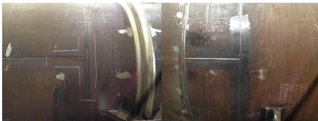
FIGURA 9. Preparação da área de varredura – Superfície de teste
