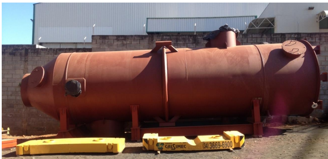
FIGURA 1. Trocador de Calor Gás-Gás
