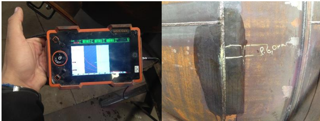
FIGURA 10. Detecção de defeito interno na junta
