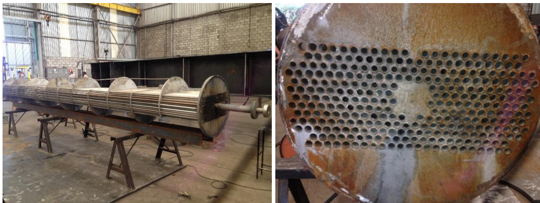
FIGURA 11. Feixe Tubular – Corrosão.
