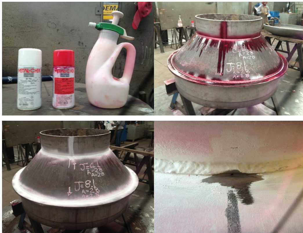
FIGURA 8. Passo a passo do Teste de Líquido Penetrante
