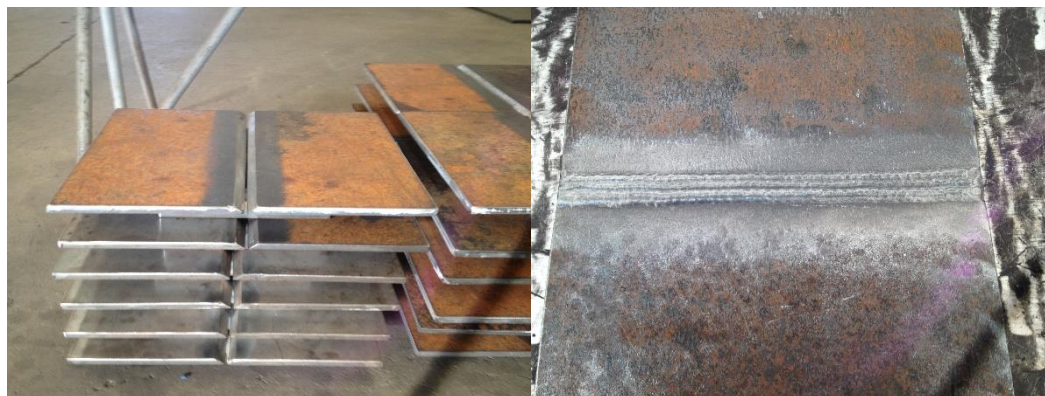
FIGURA 3. Corpo de prova plano
