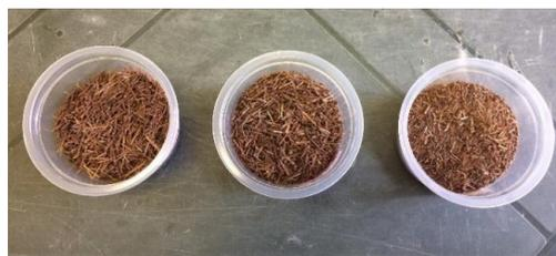
Figura 3. Fibras cortadas de comprimento 5, 10 e 15 mm (Autor, 2019).
