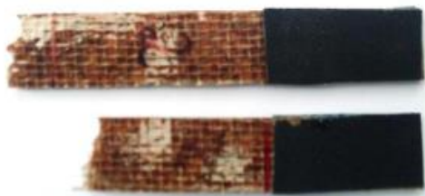
Figura 3 – Corpo de prova fraturado após o ensaio de tração.
