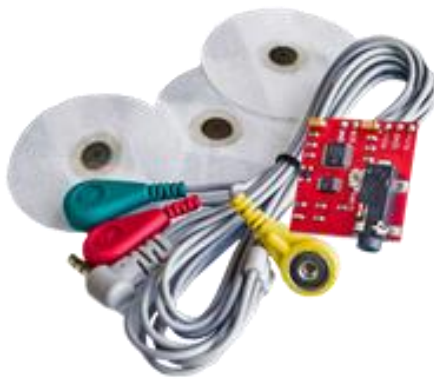
Figura 4. Vista frontal del sensor muscular, cable de conexión y electrodos
