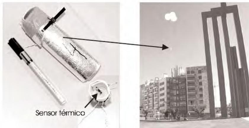
Fig. 2.5.c. À esquerda o invólucro de protecção dos registadores térmicos (tinytalk). Primeiro lançamento dos balões cativos em Telheiras, à direita (23 de Novembro de 2001).
