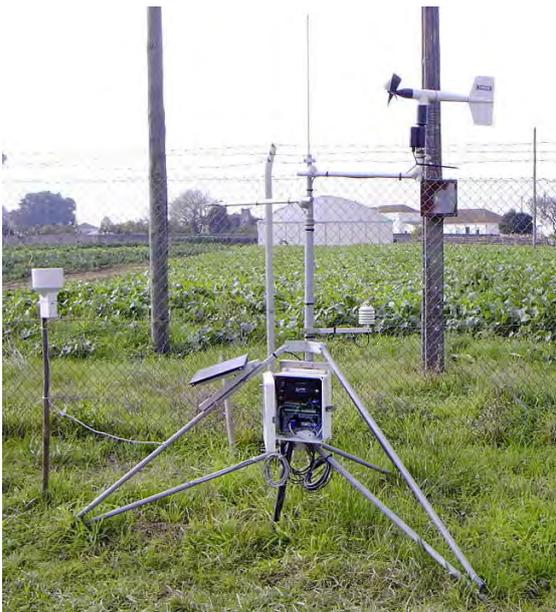
Fig.2.1.b. Estação meteorológica automática (rede macroclimática)
