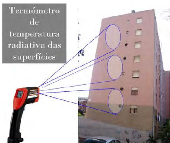
Fig. C.2. Radiómetro de superfície
