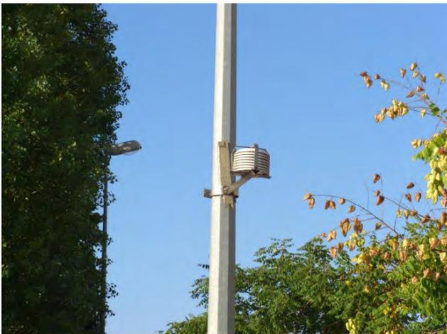
Fig.2.4.c. Registador fixo de temperatura do ar e humidade (Rede de Mesoscala do CEG)
