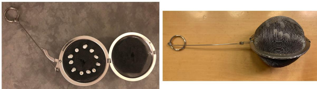
Abbildung 11 Tee-Eier mit in Schaumstoff eingebetteten Implantaten (links: offen, rechts: geschlossen und mit Draht gesichert), vorbereitet für das Thermocycling.
