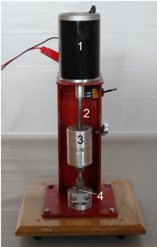
Abbildung 6 Das im Rahmen dieser Arbeit verwendete Rotationsschwinger-System. 1: Motor, 2: Übertragung der Rotation über eine Spiralfeder, 3: Schwingerkörper mit innenliegender exzentrischer Masse, 4: Probe (Implantat).
