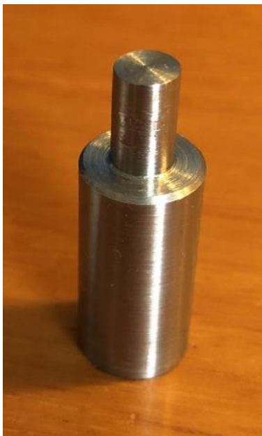
Abbildung 32 Prüfkörper aus Werkzeugstahl, aus einem Stück gedreht. Durchmesser an der breiteren Basis 12 mm, am dünneren Kopf 6 mm.
