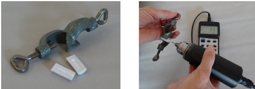
Abbildung 10 Hilfskonstruktion zur Anwendung des Anzugsdrehmoments an den nicht eingebetteten Implantaten.
