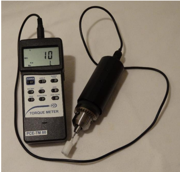
Abbildung 8 Der verwendete elektronische Drehmomentschraubendreher Modell PCE-TM 80 der Firma PCE Instruments , Meschede, Deutschland. In das Bohrfutter eingesetzt ist der mit den Implantaten mitgelieferte Steckschlüssel und ein in den Kunststoffzylinder eingeklebtes Implantat.
