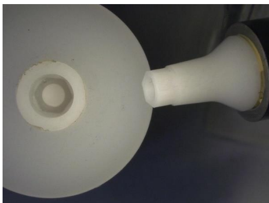
Abbildung 20 Gebrochenes Implantat vom Typ BOL-Zr TC .
