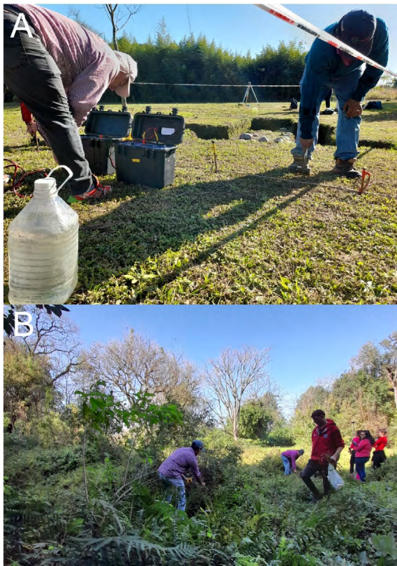
Figura 5. A: Toma de medidas paramétricas en la periferia de la ciudad. B: Calicata Eléctrica en la zona de estudio. Autoría: Florencia Borsella.
