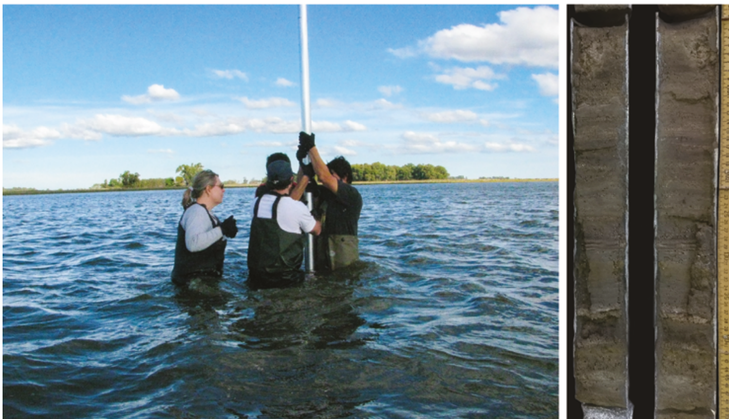
Figura 3. Izquierda. Extracción de un testigo sedimentario de la parte más profunda de una laguna pampeana utilizando un vibracore . Este dispositivo provoca vibraciones que permiten que el tubo se vaya introduciendo en el sedimento. Derecha. Vista de un testigo sedimentario luego de ser abierto en el laboratorio.
