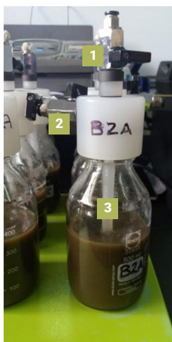
**a** Reactor anaeróbico
