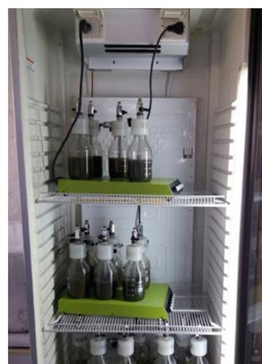
**b** Reactores anaeróbicos en incubadora regulada a 35 °C
