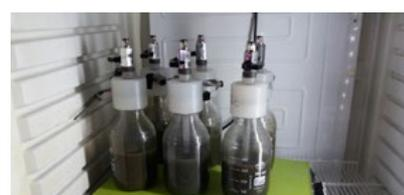
**a** Reactores anaeróbicos en agitador magnético con 6 puertos
