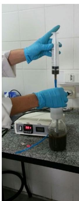
**b** Reactor anaeróbico conectado a la jeringa para muestrear la fase líquida
