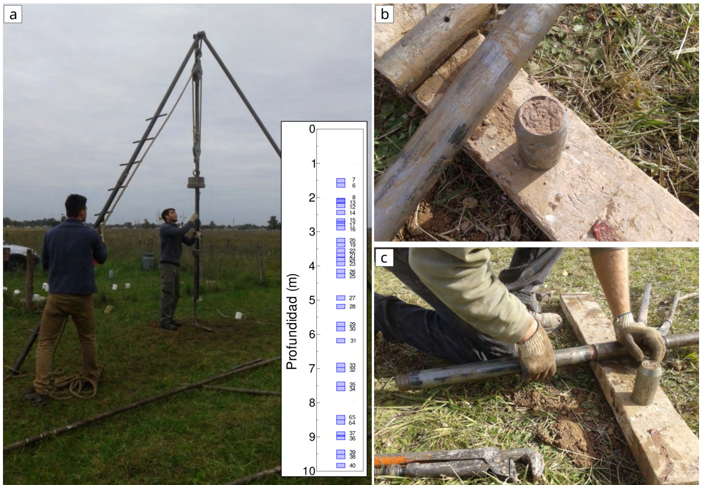
Figura 2. a) Trípod y sistema de accionamiento de la maza sobre la cabeza de golpeo. En el gráfico interior, se muestran los testigos de 13 cm de longitud que fueron recuperados (en escala); bc) detalle del sacatestigo normalizado "Terzagui".
