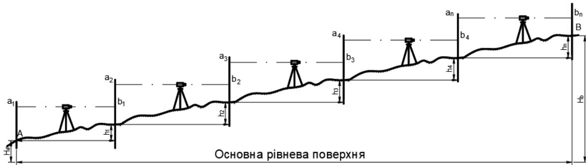
Рисунок 7.3 – Послідовно геометричне нівелювання
