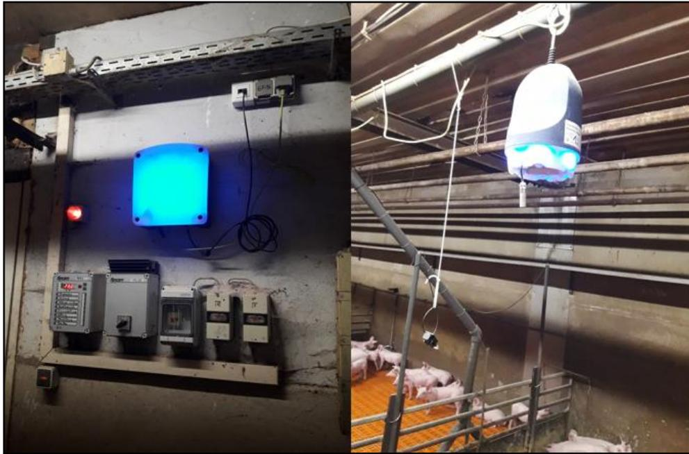
**Abbildung 4:** links: Gateway im Stallgang; rechts: SoundTalks®-Monitor im sogenannten „Wissenschaftsmodus“; LEDs blau (Quelle: eigene Aufnahmen).
