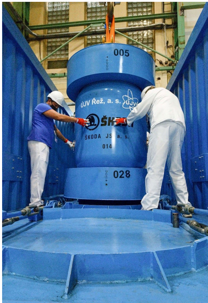
Obr. 4: Naložení obalového souboru VPVR/M v hale reaktoru
