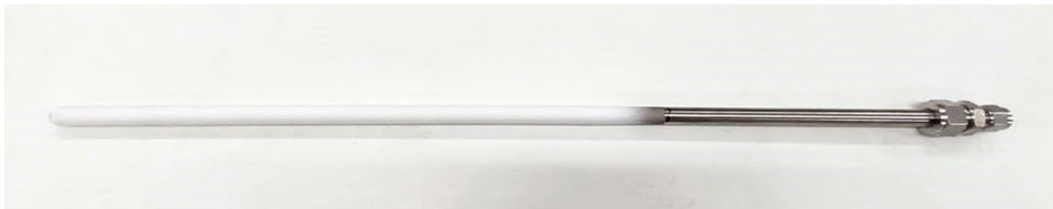
| Obr. 1: Vzorek s povlakem z \text{Al}_2\text{O}_3 |
