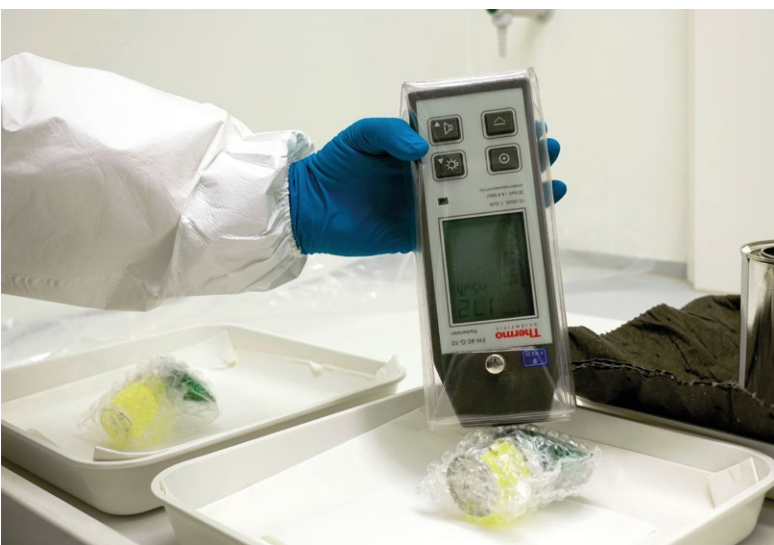
Obr. 2: Měření příkonu dávkového ekvivalentu jednoho z dodaných vzorků (foto: Michal Šafránek, ÚJV Řež)
