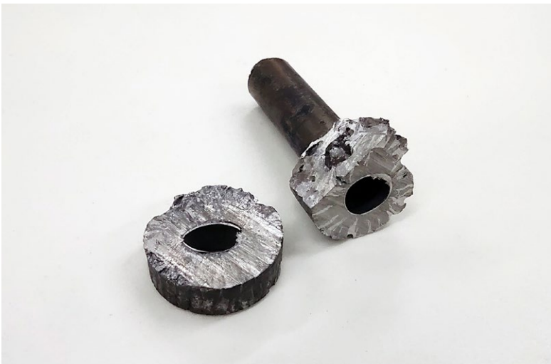
Obr. 2: Řez exponovaného vzorku z austenitické oceli po 1 000 hodinách
