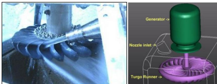
**Figura 2.31:** turbinas Turgo como mini-hidráulicas alimentadas con aguas grises de reservorios de edificios [16].
