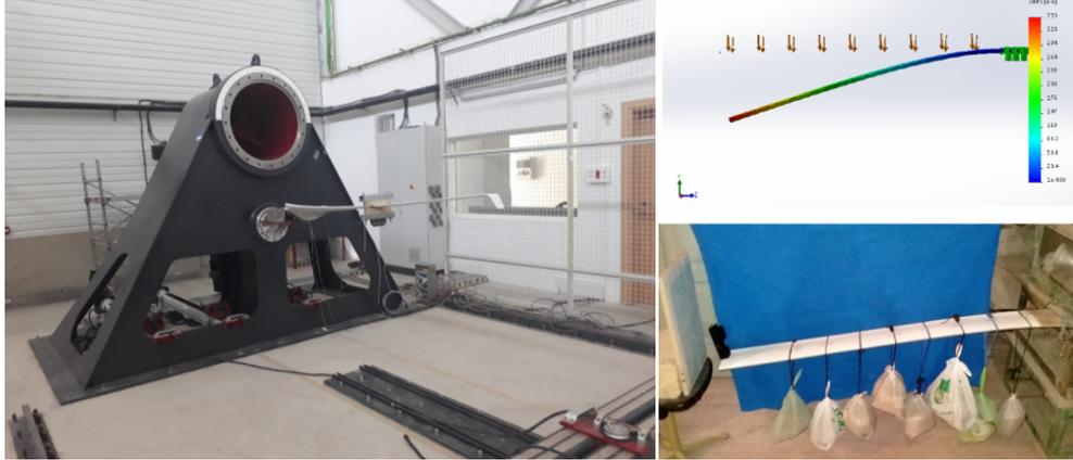
Figura 2.36: Ensayo estático de máxima carga [18]
