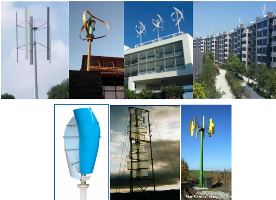
**Figura 2.4.** Turbinas de eje vertical: Arriba: H-Darrieus, Darrieus Troposkien, Darrieus Helicoidales. Abajo: Savonius helicoidal, Savonius recto en rodajas, Híbrida. [3]
