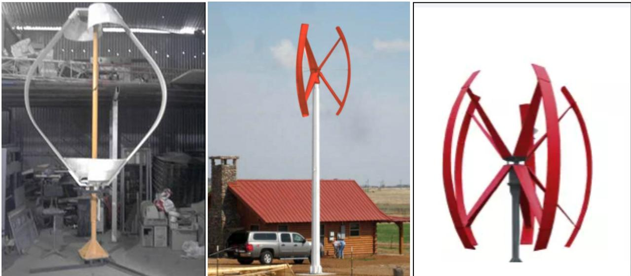
**Figura 2.28:** Turbinas de Eje Vertical Darrieus Troposkien, de 2, 3 y 5 aspas.[11, 14]
