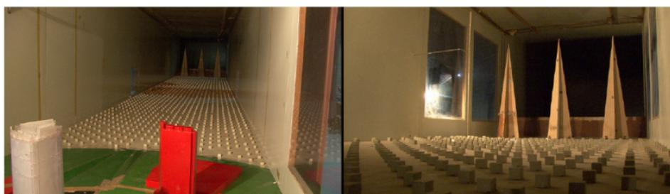
**Figura 3.6.** Vista general (izquierda) y detallada (derecha) de la configuración utilizada para la generación de una capa límite de tipo urbana, Túnel de viento de la Facultad de Ingeniería, Universidad de la República, Uruguay.
