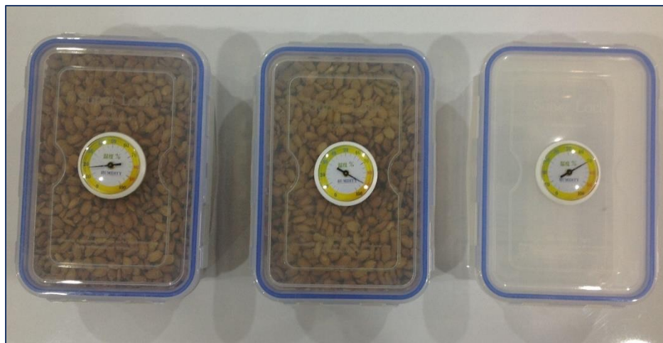
Figure 2 : Exemple de mesure de l'humidité relative de deux échantillons de blé. Une fois l'équilibre atteint, l'échantillon de gauche a une humidité relative d'environ 20 % et peut être stocké en toute sécurité. Celui du milieu a une humidité relative d'environ 90 % et doit impérativement être séché. Photo : S. Groot.
