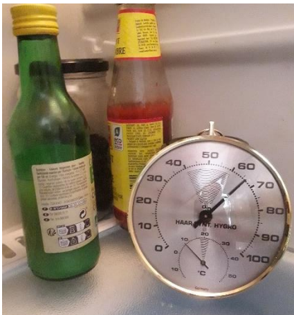
Figure 3 : Dans ce réfrigérateur, l'humidité relative est d'environ 65% - trop élevée pour le stockage de semences dans des sacs perméables.
