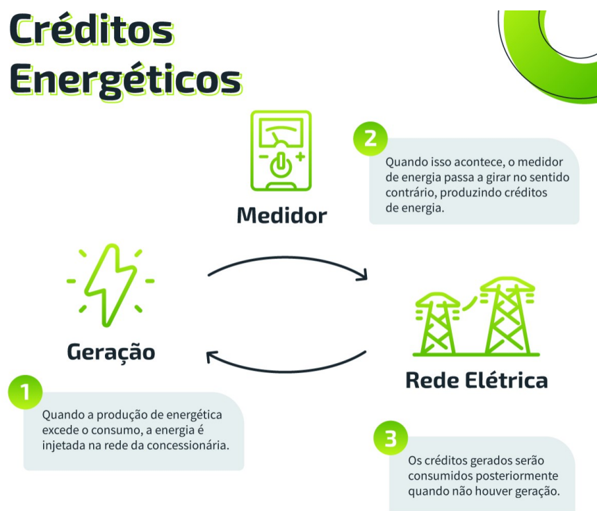
Figura 5 -Funcionamento dos benefícios dos projetos micro e minigeração de energia que solicitarem acesso junto à rede de distribuição até 2024.
