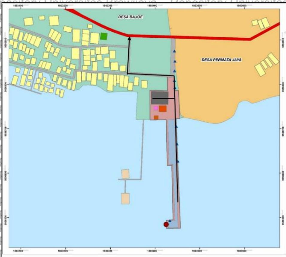
Gambar 4. 24 Sirkulasi keluar kendaraan pada Pelabuhan Penyeberangan Desa Bajoe
