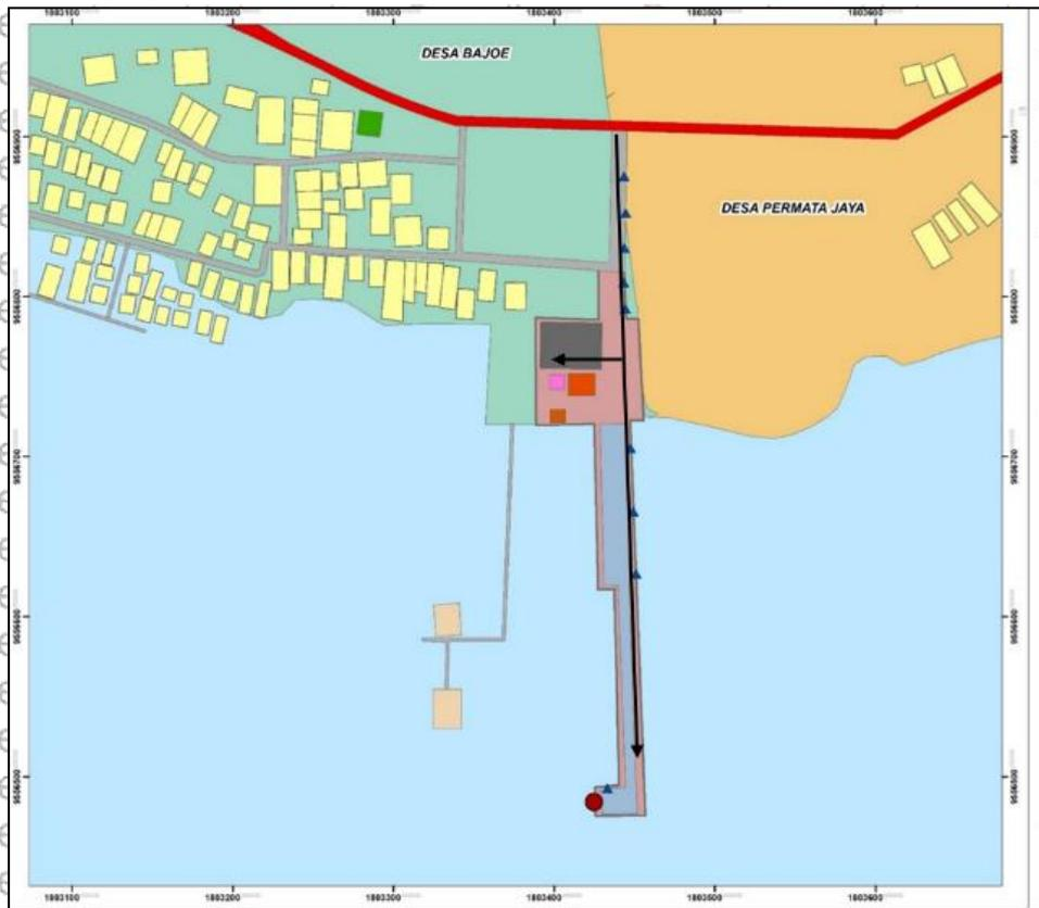
Gambar 4. 23 Sirkulasi masuk kendaraan pada Pelabuhan Penyeberangan Desa Bajoe
