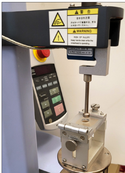
Rycina 4. Badanie odporności filmów ODF na przebicie. Figure 4. Determination of the puncture strength of ODFs.
