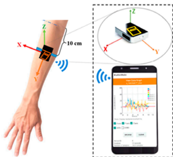
Рис. 4. Принцип работы и вариант интерфейса IMC. IMC прикреплен к предплечью при помощи самоклеящейся ленты на 10 см дистальнее латерального надмыщелка. Регистрировались четыре активных движения: отведение; сгибание; а также внутренняя ротация и наружная ротация при отведении плеча [45]
