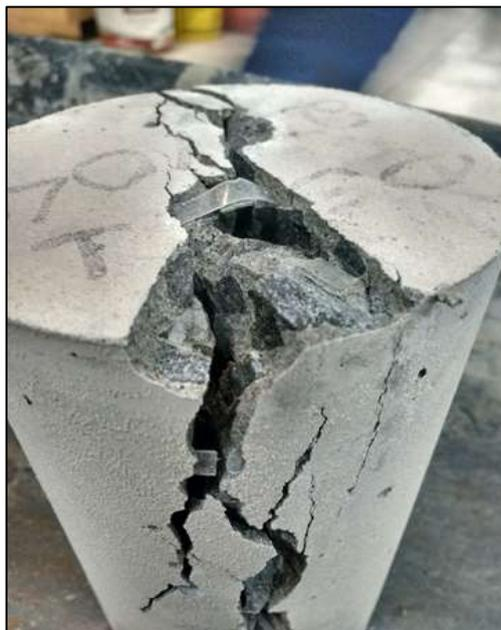
*Nota.* Vista de la rotura después del ensayo de la resistencia a la compresión. De “Fibra de PET na Produção de Concretos”, por Da Silva Rodrigues et al., 2018.
