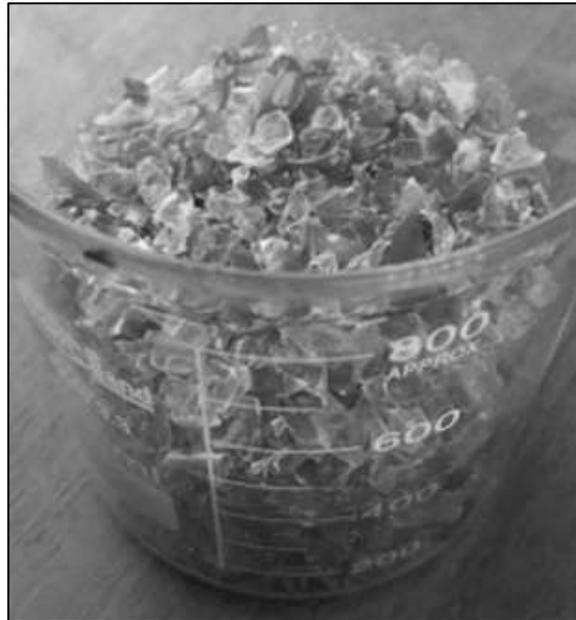
*Nota.* Composición volumétrica de los materiales compuestos ensayados: el más fino (fracción 0-4 mm) mezcla PET. De “Ultrasonic Quality Assessment of Polymer-Cement Concrete with Pet Waste as the Aggregate”, por Sokolowska y Zalegowski, 2018.
