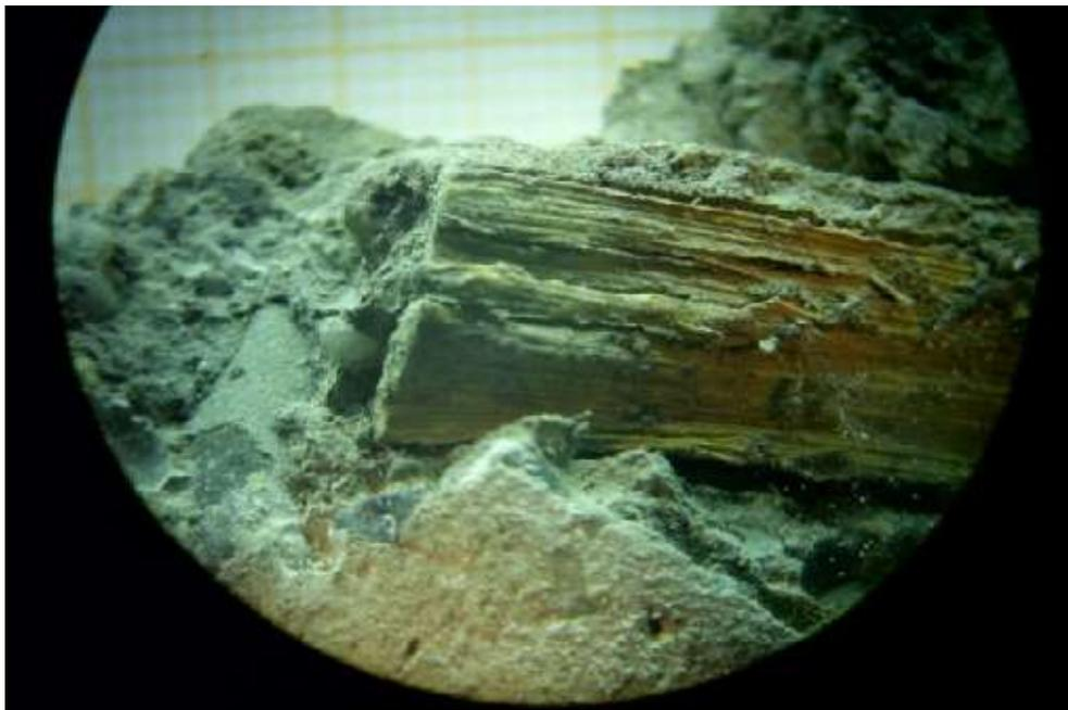
*Nota.* Mezclas de concreto reforzado con fibras de bagazo de caña de tamaño corto presentando mala adherencia. De “Studies of the mechanical properties of concrete reinforced with sugar”, por Paricaguán Morales y Muñoz Cuevas, 2019.
