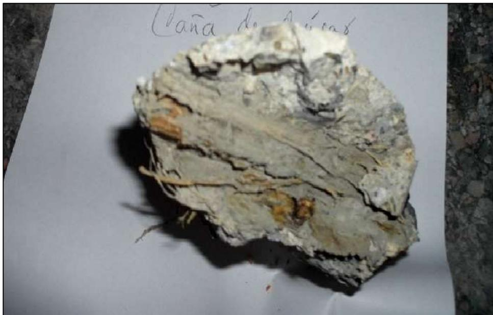
*Nota.* Impregnación incompleta de las fibras de bagazo de caña de azúcar con el PMMA. De “Studies of the mechanical properties of concrete reinforced with sugar”, por Paricaguán Morales y Muñoz Cuevas, 2019.
