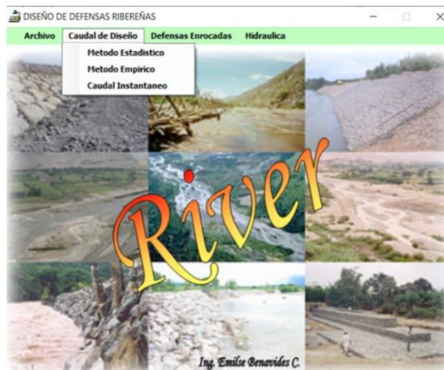
*Nota.* En la figura se muestra los tres métodos que el programa River considera para realizar el cálculo de Diseño.
