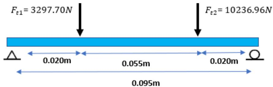
Usando la herramienta SKYCIV obtenemos las reacciones en el primer eje en el plano XY
