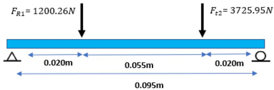
Usando la herramienta SKYCIV obtenemos las reacciones en el primer eje en el plano XY
