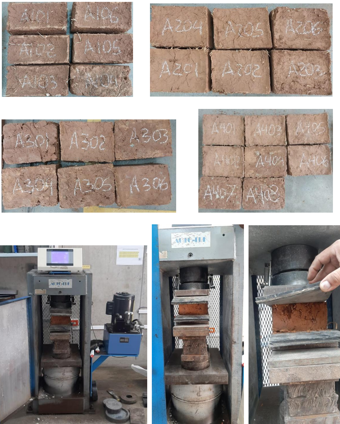
Figura 30: Se realizó el ensayo de compresión a 26 bloques de adobe, 1er grupo 6 adobes tradicional, 2do grupo 6 adobes por la norma E-0.80, 3er grupo 6 adobes con adición del 7.5% de papel reciclado y 4to grupo 8 adobes con la adición del 12.5% de papel reciclado
