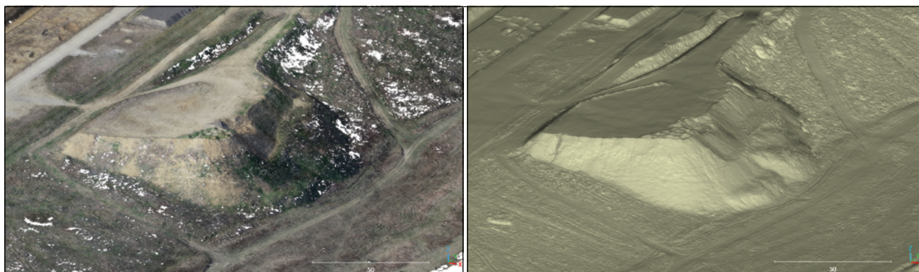
11. ábra. A leválogatott talajpontok pontfelhője és az ezekből levezett digitális terepmodell
