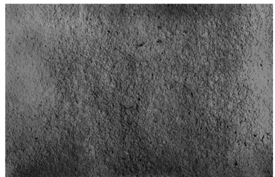
Рис. 9. Поверхня сплаву Fe_{70,3}Ni_{29,7} , отриманого імпульсним струмом ( f = 30 Гц, Q = 32 ).
